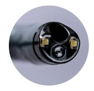
Estremità distale Contiene la camera, la sorgente luminosa (due LED) e l'uscita del canale di lavoro
